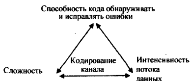
Рис. 1.3. Взаимосвязь между параметрами кодовых конструкций.
