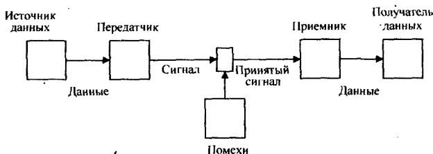
Рис. 1.1. Модель передачи информации по каналу связи по К. Шеннону.
