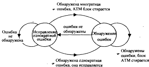
Рис. 3.27. Модель передачи блоков АТМ по каналу с двумя состояниями.
