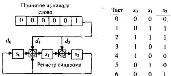
Рис. 3.23. Модифицированный алгоритм вычисления синдрома с предварительным умножением вектора ошибки на d(X) = X^2 + X .
